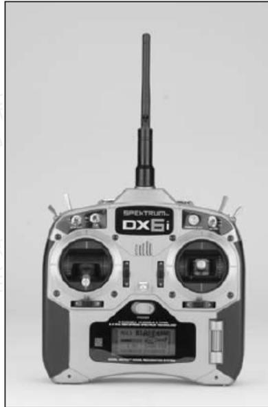
4. Ziehen Sie und halten Sie den Trainerschalter vorne am Sender nach oben und schalten Sie dann den Sender ein. Innerhalb einiger Sekunden bindet sich der Empfänger an den Sender. Die LED's hören auf zu blinken und schalten um auf Dauerleuchten, dies signalisiert das der Bindevorgang erfolgreich war.
