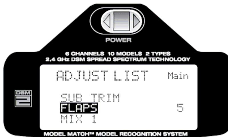
Durch Drücken der Taste aktivieren Sie die „FLAP“ Funktion
