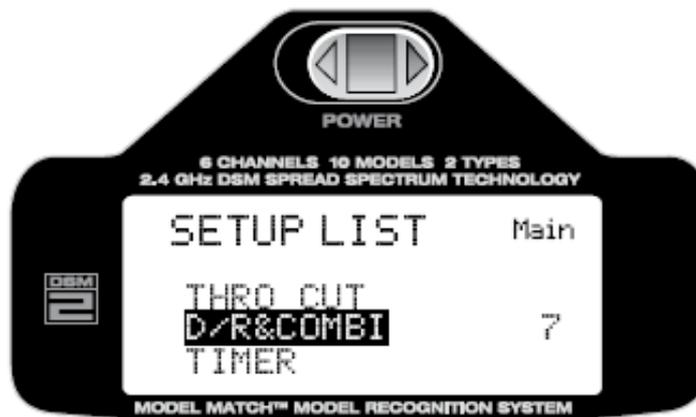
Um die „Dual Rate Combi“ Funktion zu aktivieren, blättern Sie mit der Roll-Funktion der Roll-Drucktaste zur Anzeige D/R Combi in der Liste und aktivieren diese durch einen Druck auf die Taste.
