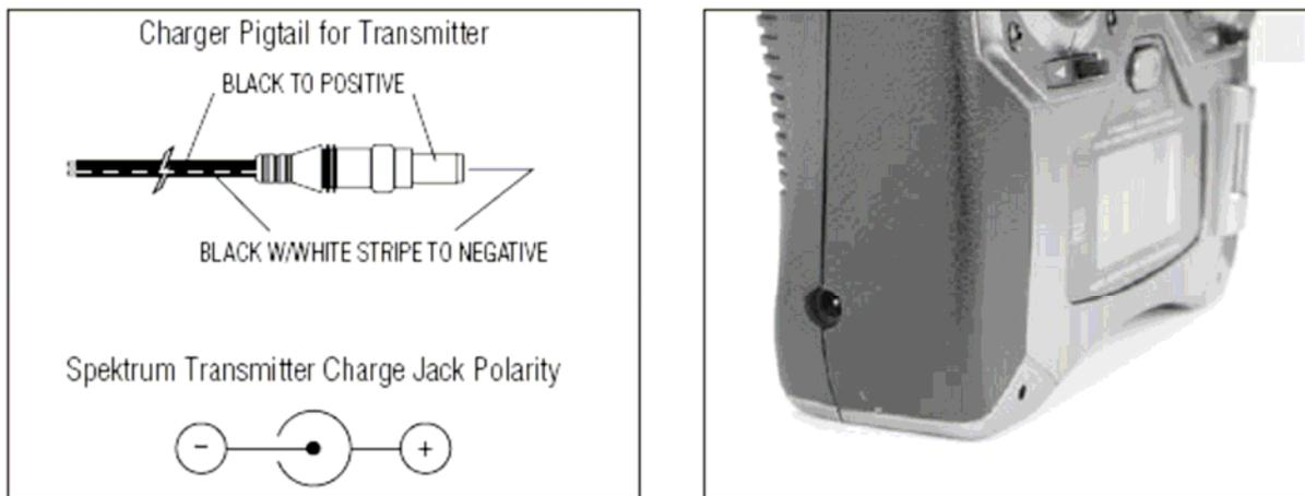
Die Ladebuchse für den Senderakku befindet sich auf der linken Seite im Sendergehäuse.
