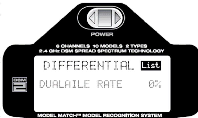
Mit der Roll-Funktion wählen Sie die Werteeinstellung im Display aus (0%). Drücken Sie die Taste um die Auswahl der Werteingabe zu aktivieren. Mit der Roll-Funktion können Sie nun die Werte verändern. Durch anschließendes Drücken der Taste wird der Wert gespeichert.
