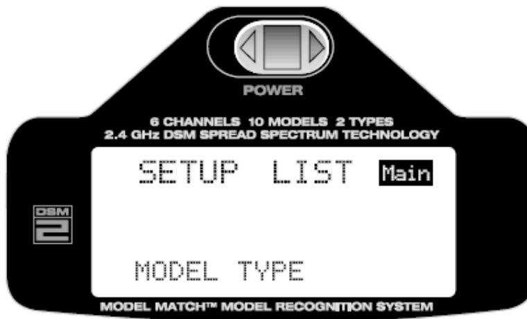
Mit der Roll-Funktion der Roll-Drucktaste aus der „SETUP LIST“ die Servo- Richtungsumkehr (REVERSE) auswählen.
