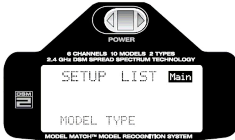
Alternativ dazu können Sie auch bei bereits eingeschaltetem Sender und der Display Grundanzeige, durch Drücken der Roll-Drucktaste in den Programmier Modus gelangen. Mit der Roll- Funktion können Sie jetzt durch die Auswahlliste (SETUP LIST) blättern.
