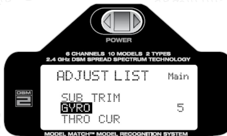
Durch Drücken der Taste aktivieren Sie die „Gyro“ Funktion.
