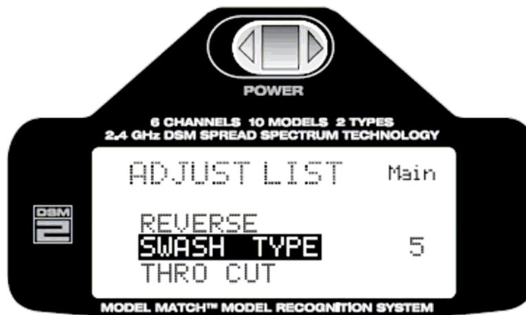
Mit der Roll-Funktion der Roll-Drucktaste 1 Servo 90° (1 servo 90 degrees) oder CCPM 120° (CCPM 120 degrees) Taumelscheibe auswählen.
