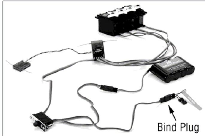
**2.** Schalten Sie nun den Empfängerschalter ein. Die LED's in den Empfängern beginnen zu blinken und signalisieren damit das sich der Empfänger im Bindevorgang befindet.
