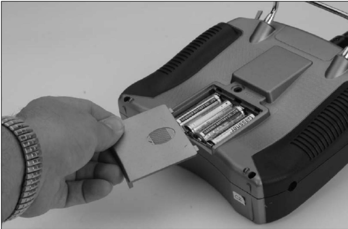
Entfernen Sie den Batteriedeckel auf der Rückseite des Senders und legen Sie 4 Stück AA Batterien in den Batterieschacht ein. Achten Sie dabei auf die richtige Polarität der Batterien zueinander. Eine Symbolabbildung auf dem Schachtboden erklärt wie die Batterien eingesetzt werden müssen. Nach dem Einlegen der Batterien/Akkus, das Batteriefach wieder verschließen.
