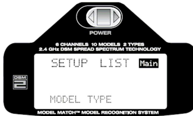
Mit der Roll-Funktion der Roll-Drucktaste blättern Sie durch die Liste und wählen die Funktion "Range Check" aus.
