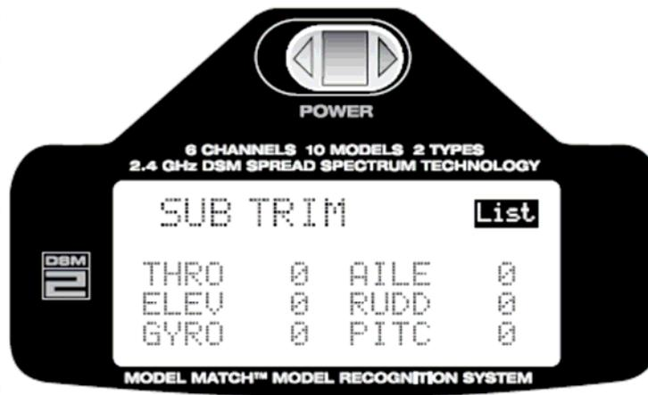
Mit der Roll-Funktion der Roll-Drucktaste wählen Sie den Wert aus der verändert werden soll. Drücken der Taste und anschließendes Rollen verändert den Wert. Rollen nach links verändert den Wert nach links vom Neutralpunkt. Rollen nach rechts verändert den Wert nach rechts vom Neutralpunkt, dies wird auch von einem kleinen Pfeilsymbol vor dem Einstellwert angezeigt. Durch anschließendes Drücken der Taste wird der eingestellte Wert gespeichert.
