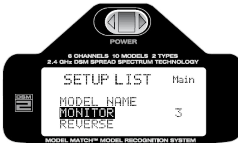
Durch Drücken der Roll-Drucktaste den Servo Monitor aktivieren. Durch Bewegen der Steuerknüppel und Schalter können Sie nun die Funktion der Servoausgänge kontrollieren.
