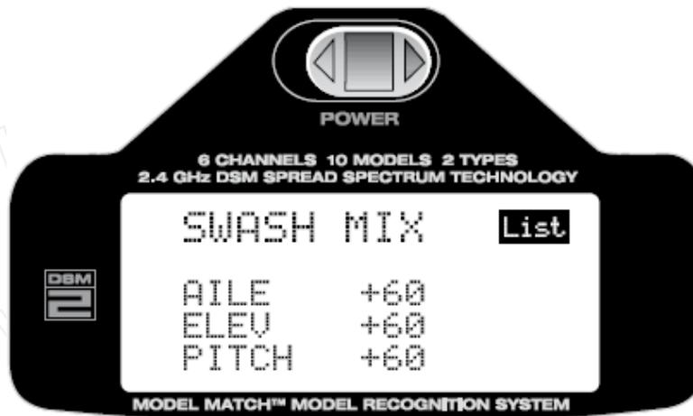
Mit der Roll-Funktion der Roll-Drucktaste wählen Sie den Wert aus der verändert werden soll.
