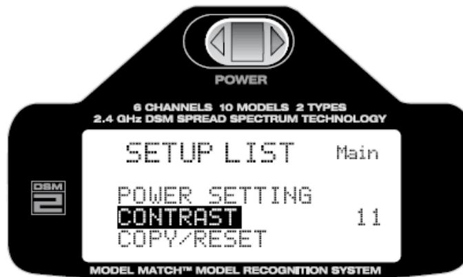
Mit der Roll-Funktion blättern Sie durch die Liste und wählen „Contrast“ aus. Durch Drücken der Taste gelangen Sie in die Einstellungen.
