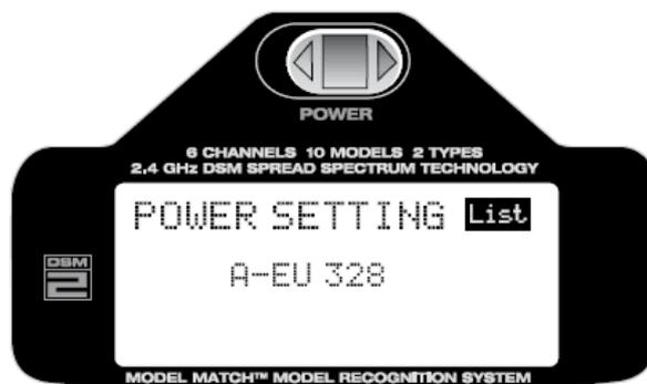
Mit der Roll-Funktion der Roll-Drucktaste aktivieren Sie die Anzeige in der zweiten Zeile. Durch Drücken der Taste und anschließendes rollen, können Sie zwischen beiden Einstellungen Auswählen. Wählen Sie hier A-EU 328 aus und bestätigen Sie die Einstellung durch Drücken der Taste. Beachten Sie unbedingt die Hinweise in der Einleitung zu diesem Menüpunkt.
