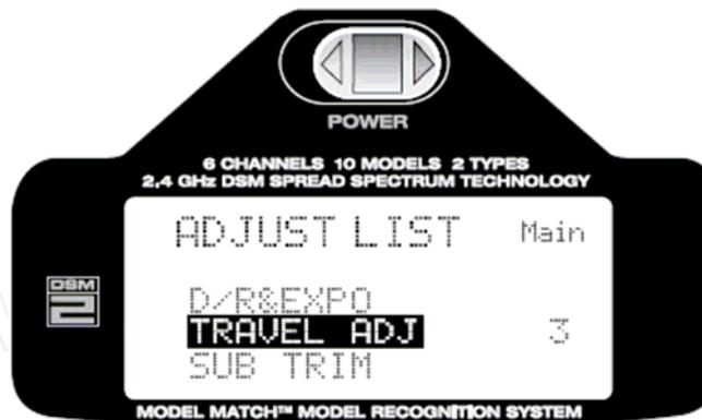
Durch Drücken der Taste aktivieren Sie die „Travel Adjust“ Funktion
