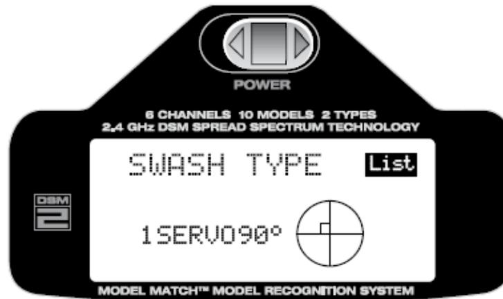
Nach dem die gewünschte Taumelscheibe ausgewählt ist, drücken Sie die Roll-Drucktaste um die Taumelscheibe zu aktivieren.
