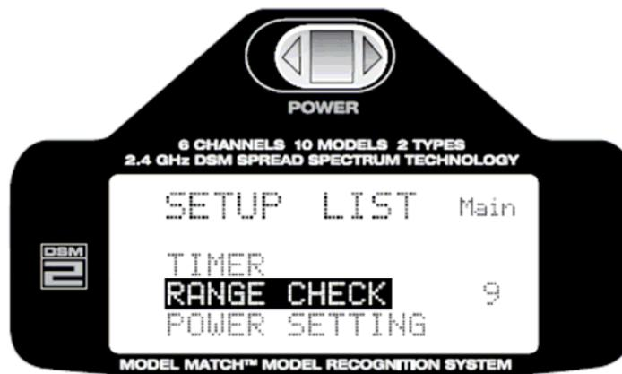
Durch Drücken der Roll-Drucktaste aktivieren Sie nun die Testfunktion.
