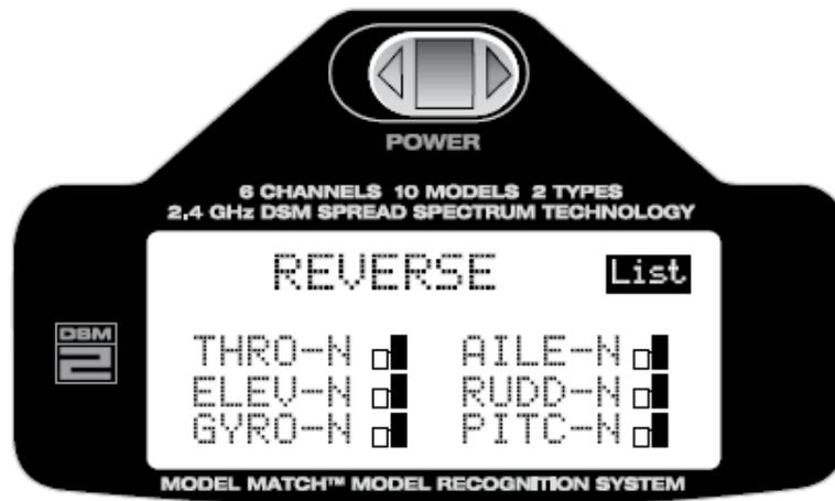
Wenn der gewünschte Kanal ausgewählt ist, kann mit der Roll-Funktion die Drehrichtung umgekehrt werden (N=Normal, R=Reverse).
