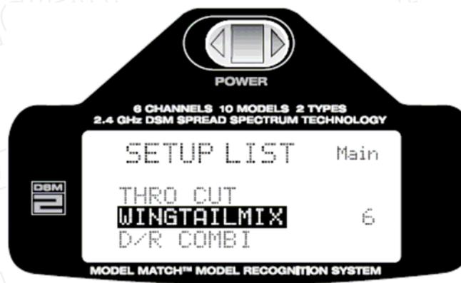
Durch Drücken der Roll-Drucktaste die Funktion „WINGTAILMIX“ aktivieren.
