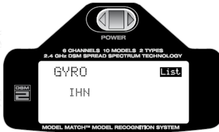
Mit der Roll-Funktion der Roll-Drucktaste wählen Sie „INH“ aus und drücken die Taste. Mit der Roll-Funktion ändern Sie die Anzeige von „INH“ inaktiv auf „ACT“ aktiv.
