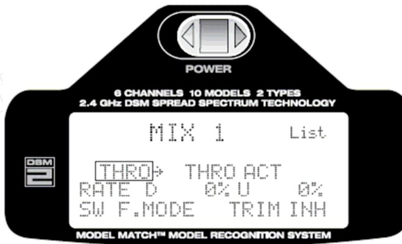
Drücken Sie die Taste um die Auswahl der möglichen Geber-Kanäle zu aktivieren, mit der Roll-Funktion können Sie nun durch die Kanäle blättern und durch anschließendes Drücken der Taste wird der ausgewählte Kanal als Geber-Kanal gespeichert.
