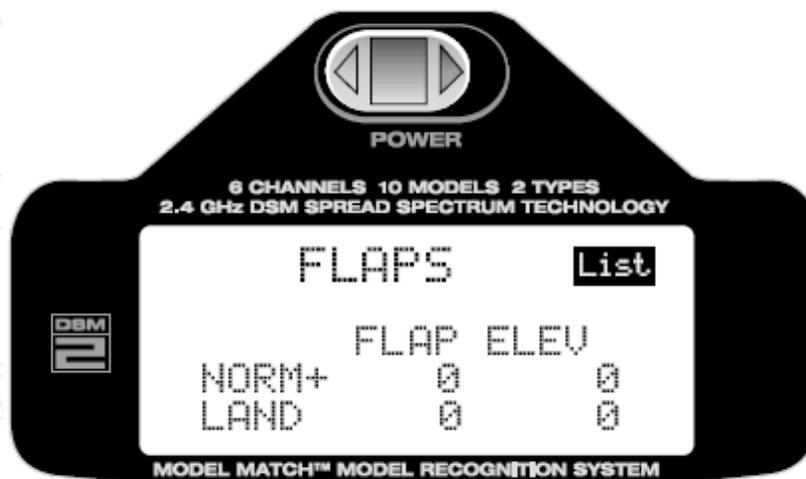
Mit der Roll-Funktion der Roll-Drucktaste wählen Sie den Wert aus der verändert werden soll, FLAP=Querruder, oder ELEV= Höhenruder. Drücken der Taste und anschließendes Rollen verändert den Wert. Somit können Werte nach oben oder unten vom Neutralpunkt eingestellt werden. Je nach Flugzeugtyp kann eine Zumischung von Höhen- oder Tiefenruder zu der jeweiligen Flapstellung erforderlich sein. Durch anschließendes Drücken der Taste wird der eingestellte Wert gespeichert.
