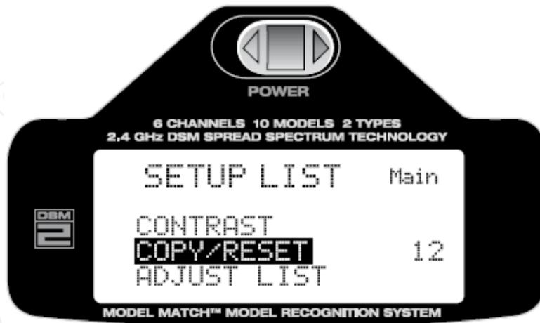
**Alternativ** dazu können Sie auch bei bereits eingeschaltetem Sender in der Display Grundanzeige, durch drücken der Roll-Drucktaste (ca. 3 Sec.) in den Programmier-Modus gelangen. Nach loslassen der Taste erscheint „Setup List“ auf dem Display. Blättern Sie mit der Roll-Funktion der Roll-Drucktaste nach unten durch die Liste und wählen Sie „Copy/Reset“ aus.
