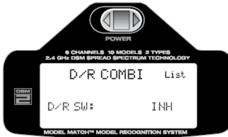
Mit der Roll-Funktion wählen Sie "INH" aus und aktivieren die Funktion durch einen Druck auf die Taste. Wählen Sie jetzt mit der Roll-Funktion (AILE) Querruder, (ELEV) Höhenruder, (RUDD) Seitenruder oder (FM) Flugphasenschalter aus. Bitte beachten Sie hierzu auch die Anleitung auf Seite 109 für Modellspezifische Einstellungen.
