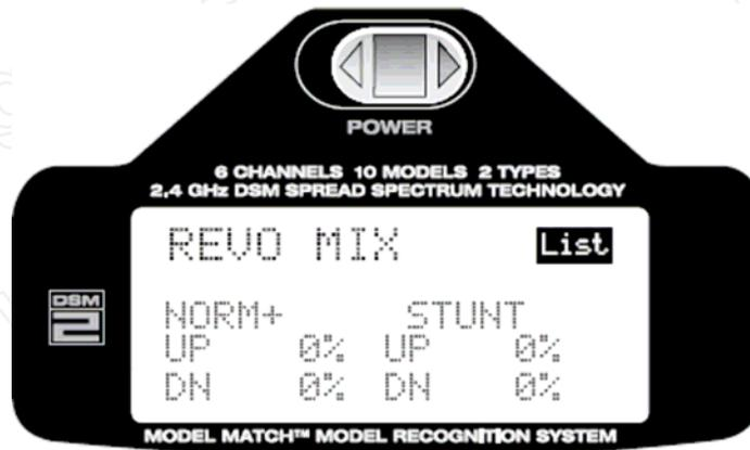
Mit der Roll-Funktion wählen Sie den Wert aus den Sie einstellen bzw. anpassen wollen. Drücken Sie die Taste um die Auswahl der Werteingabe zu aktivieren. Mit der Roll-Funktion können Sie nun die Werte verändern. Durch anschließendes Drücken der Taste wird der Wert gespeichert.
