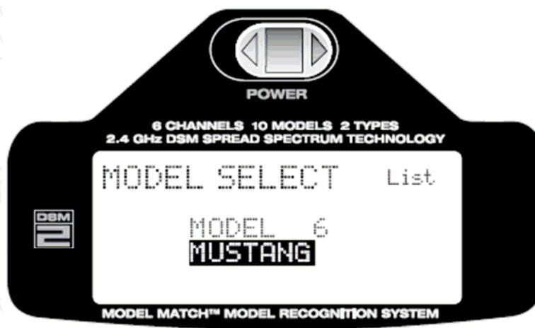
Mit der Roll-Funktion blättern Sie durch den Modellspeicher und wählen das gewünschte Modell aus den 10 möglichen Speicherplätzen durch Drücken der Taste aus. Durch erneutes Drücken der Taste, wird das im Speicher abgelegte Modell aktiviert. Unten im Display erscheint die Anzeige „Download“ gefolgt von einem Signalton als Bestätigung für den Modellwechsel.
