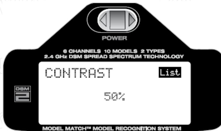
Mit der Roll-Funktion springen Sie zur Auswahl des Wertes, durch Drücken der Taste und anschließendes Rollen können Sie den Wert und somit den Kontrast Ihren Bedürfnissen anpassen. Durch erneutes Drücken der Taste wird der gewählte Wert gespeichert.
