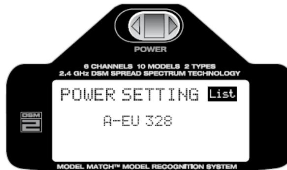
Mit der Roll-Funktion der Roll-Drucktaste aktivieren Sie die Anzeige in der zweiten Zeile. Durch Drücken der Taste und anschließendes Rollen, können Sie zwischen beiden Einstellungen Auswählen.
