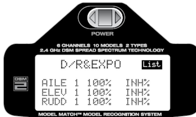
Bewegen Sie den jeweiligen D/R Schalter in die Position die Sie verändern möchten (0 oder 1) Mit der Roll Funktion wählen Sie den Wert aus den Sie verändern wollen, links befinden sich die D/R Werte, rechts (INH) die Expo Werte. Durch Drücken der Taste gelangen Sie in die Einstellungen, mit der Roll-Funktion können Sie nun den Wert einstellen. Durch Drücken der Taste wird die Einstellung gespeichert.
