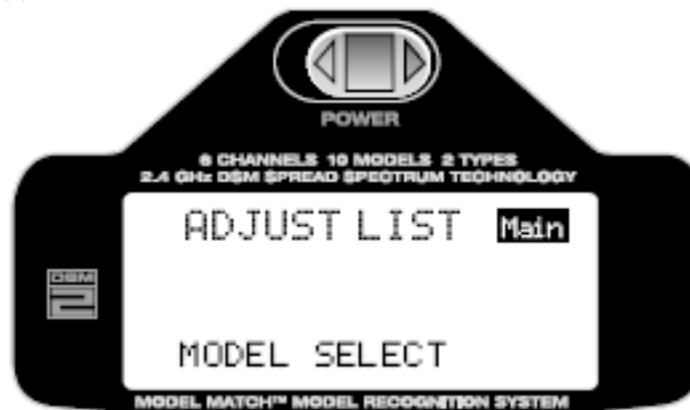
Mit der Roll-Funktion der Roll-Drucktaste wählen Sie "MODEL SELECT", Modellauswahl
