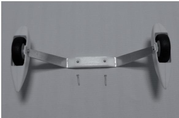
Montieren Sie zunächst das Hauptfahrwerk unter Verwendung der beiliegenden Schrauben.
