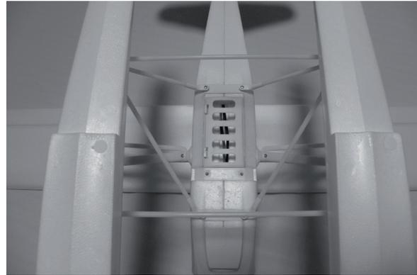
Die Montagepunkte für die Schwimmerstreben liegen vor und hinter dem Batteriefach.
