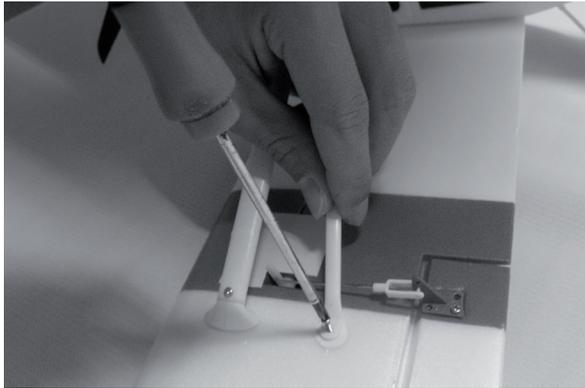
Die Tragflächenstreben werden an Rumpf und Tragfläche mit Schrauben befestigt.
