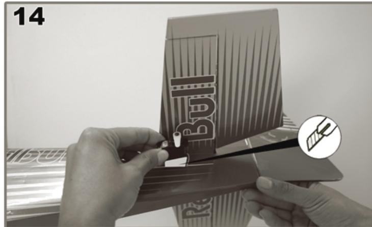
Den oberen Kasten des Seitenruderservos erfüllen und die Folie ausschneiden.
