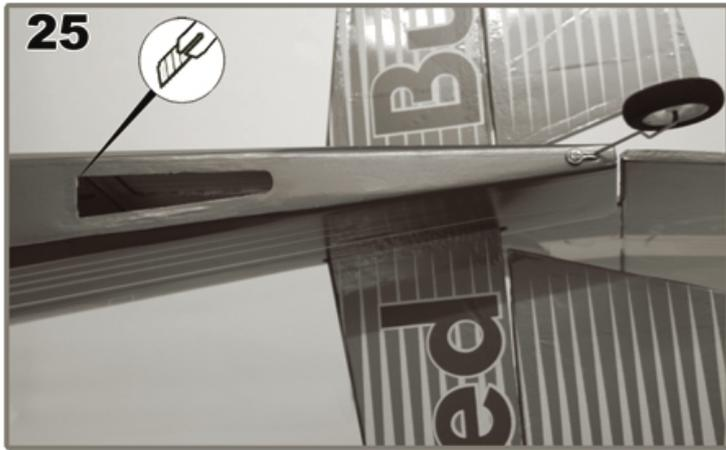
Die im Bild gezeigte Kühlluftöffnung im Rumpfboden erfühlen und vorsichtig ausschneiden.
