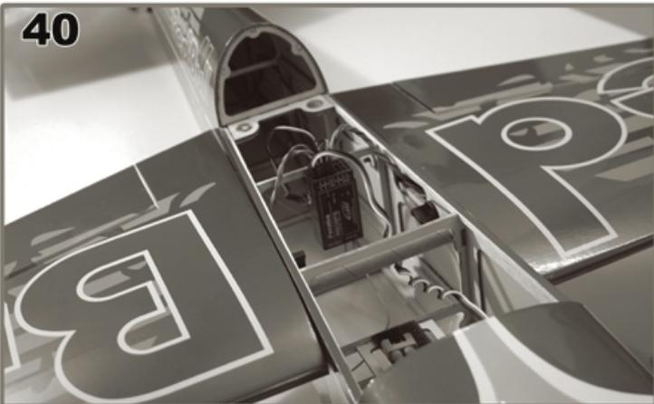
Den Empfänger im Rumpf mit etwas Doppelklebeband montieren und die elektrischen Verbindungen herstellen. Verfahren Sie dazu wie in der Betriebsanleitung ihrer Fernsteuerung angegeben!
