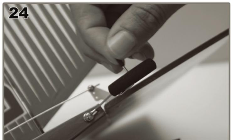
Den Schrumpfschlauch auf die Radachse schieben und durch vorsichtiges Erwärmen sichern.
