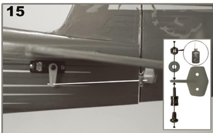
Durch provisorische Montage des Gestänges incl. Gestängeanschluss die Montageposition des Ruderhorns ermitteln und markieren. Die Mutter mit Schraubensicherung versehen und am Gestängeanschluss nur so fest anziehen, dass dieser im Ruderhorn leicht beweglich bleibt.
