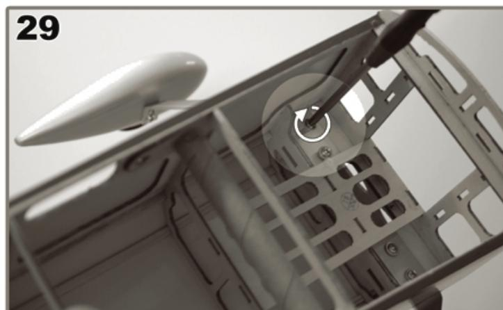
Die beiden Fahrwerksbügel im Rumpf ausrichten und verschrauben.
