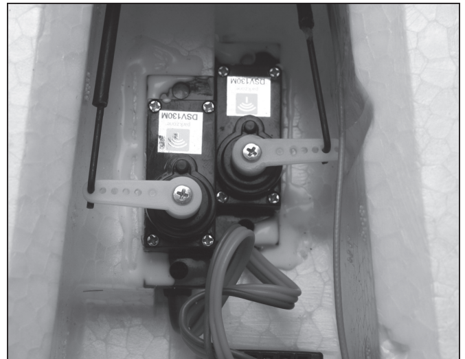
Extreme Rudereinstellungen für Seiten- und Höhenruder Servoarme und Gestänge
