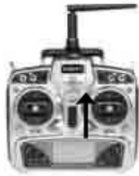
2. Stellen Sie den Gastrimmer und Gashebel auf die niedrigste Position. Roll-, Nick- und Geartrimmer auf Neutralposition stellen.
