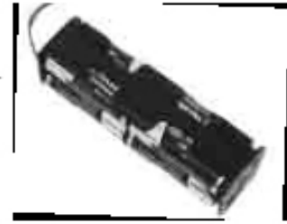
Entweder 1,5V x 8AA Batterien oder eine 1,2V x NiCd (9,6V 650mAh) Zelle passend zu den richtigen Polen montieren.
