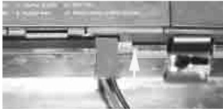
Den JST Stecker wie auf dem Bild dargestellt einstecken: Die flache Seite des Steckers sollte nach oben zeigen.
